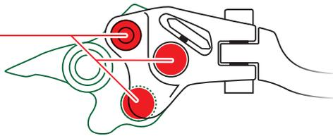
高精度切削と3点連結で負荷が分散。
