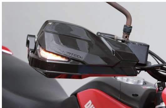
▲エクステンションセット・LEDウインカーセット装備
