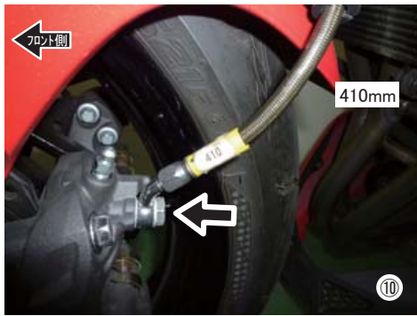
⑩ 左キャリパーにアダプター45を取り付け、ホース410mmを取り付けます。
