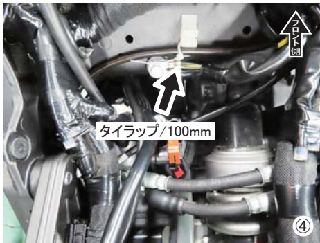
④ キャリパー側：純正ホースマウントにホース /1085mm を、タイラップ /100mm で固定します。
