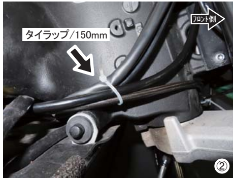
① マスター側：ホース /1135mm とスイッチハーネスを、タイラップ /150mm でまとめます。
