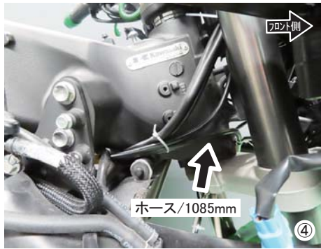
⑤ アンダーステム前方にホース /1085mm を通し、 フィッティングアダプター 90° ・ 2WAY アダプター (付属の M6 × 15 ボルトを使用) の順に取り付けます。
