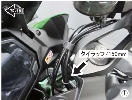
① マスター側：ホース /1135mm とスイッチハーネスを、タイラップ /150mm でまとめます。
