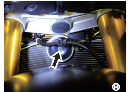
⑨ ホースクランブラバーをハサミ・カッターナイフ等で切り込みを入れ、ホースに通してステム下クランプ部に固定します。
