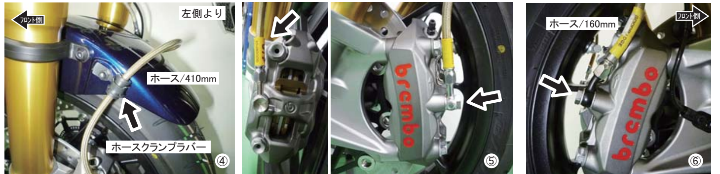
④ ホースクランプラバーをハサミ・カッターナイフ等で切り込みを入れ、ホース/410mmに通しフェンダー左側のクランプ部に通します。 ⑤ 左キャリパーにアダプターST(ST)を取り付け、ホース/410mmを取り付けます。※キャリパー取り付けボルトが外せるように少し外向きに ⑥ 右キャリパーにアダプター20(ST)を取り付け、ホース/160mmを取り付けます。
