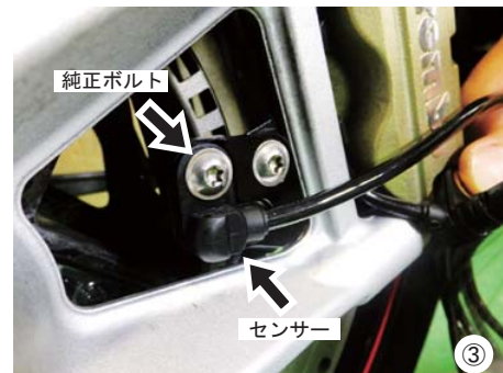
③ ブラケットにセンサーを純正ボルトで取り付けます。
