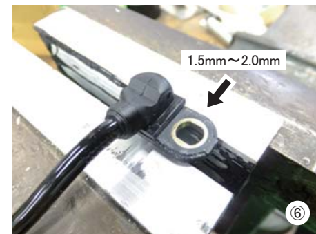
⑤ その際にはセンサーのボルト取り付け部を棒ヤスリ等を使用して、ボルトが接触しない高さまで削ってください。(1.5mm~2.0mm)
