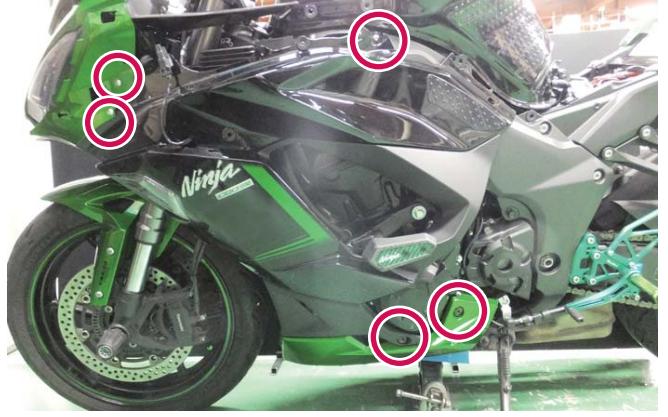
2-4. ボルトを取り外します。(5カ所)
