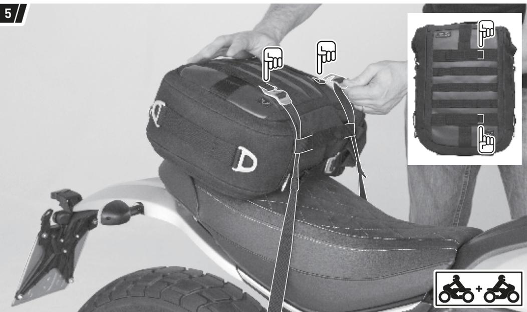
5) テールバッグのループにストラップのフックバックルを固定します。
