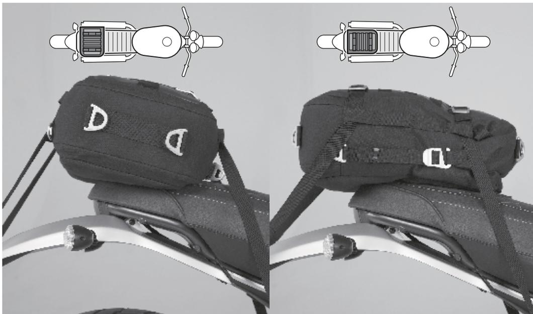
テールバッグは使用する車両に合わせて縦方向又は横方向にシートへ固定できます。
