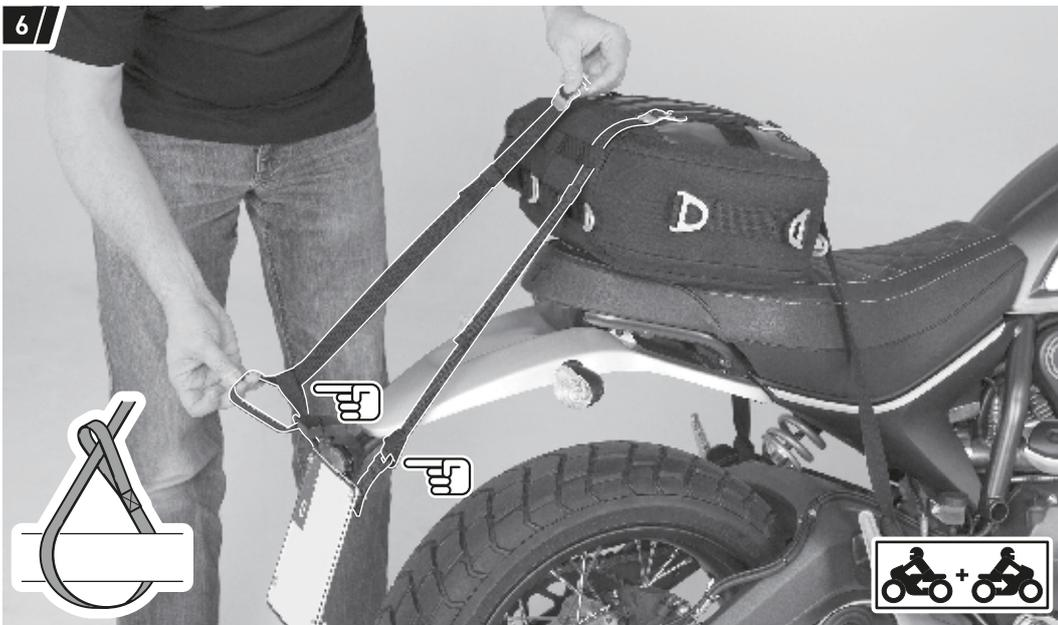
6) 両方のストラップを車体後側の取り付けに適した場所に絡ませます
