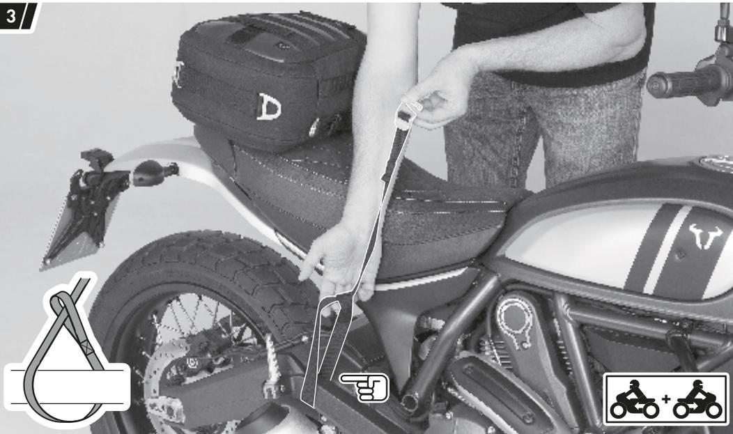
3) タンデムステップやフレームなど取り付けに適した場所にストラップを絡ませます。
