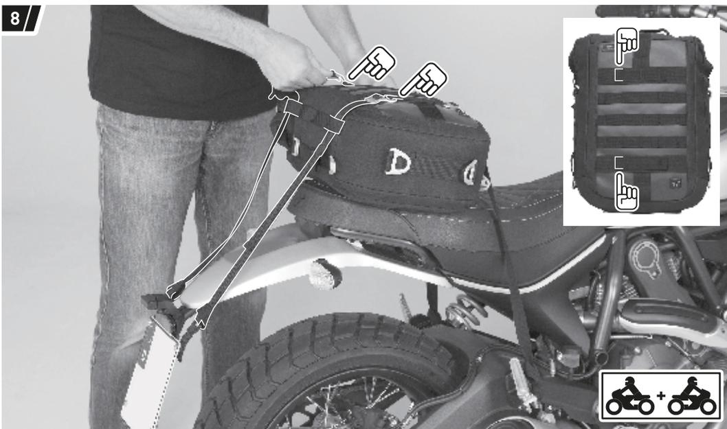
8) テールバッグのループにストラップのフックバックルを固定します。
