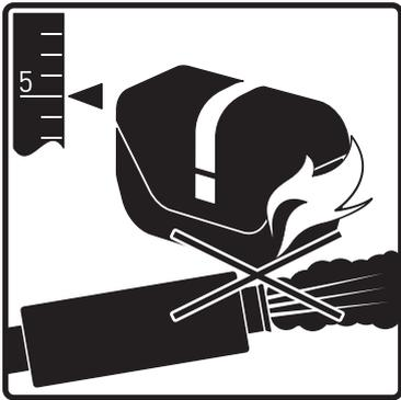
マフラーや高温になる箇所から十分に隙間がある事を確認してください。最低でも5cmは隙間を確保してください。商品が燃える恐れがあります。
