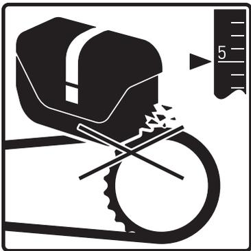
回転部から十分に隙間がある事を確認してください。最低でも5cmは隙間を確保してください。商品が回転部に巻き込まれる恐れがあります。
